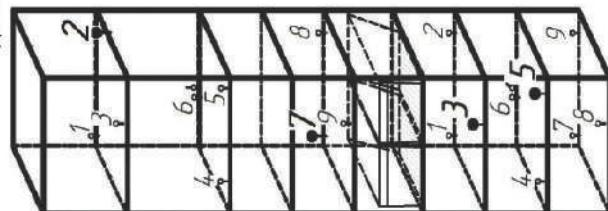
Temperatura окружющей среды +25 °C. На предприятии установлена температура в холодильной камере 5°C, значение рабочего диапазона ±2°C. В морозильной камере установлена температура -25 °C, при этом температура в морозильной камере должна быть: от (Туст. +5)°C – на верхней и нижней полках; на средней полке – (Туст.) °C.
